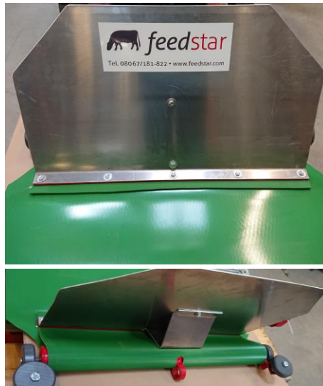
Abb. 31 Montage Schild Zugbalken
