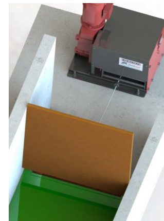
Abb. 27 Montage Seil und Seilstopper
