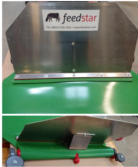
Abb. 29 Montage Schild Zugbalken
