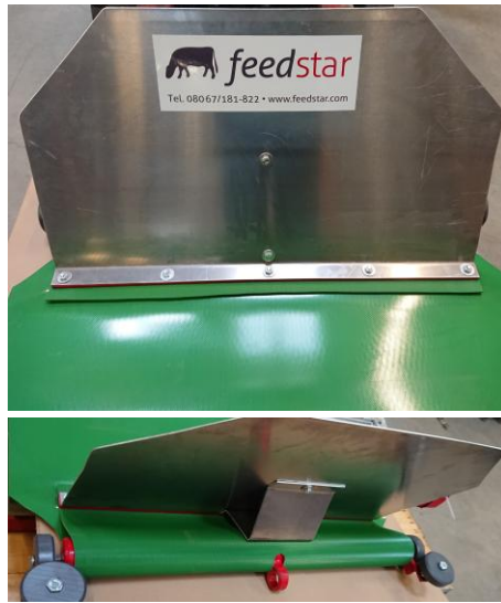
Abb. 29 Montage Schild Zugbalken
