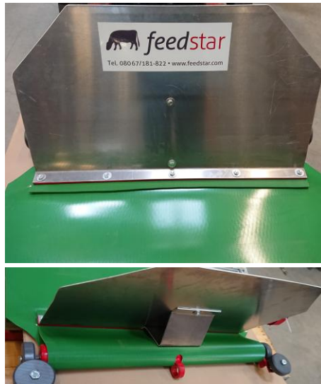
Abb. 29 Montage Schild Zugbalken
