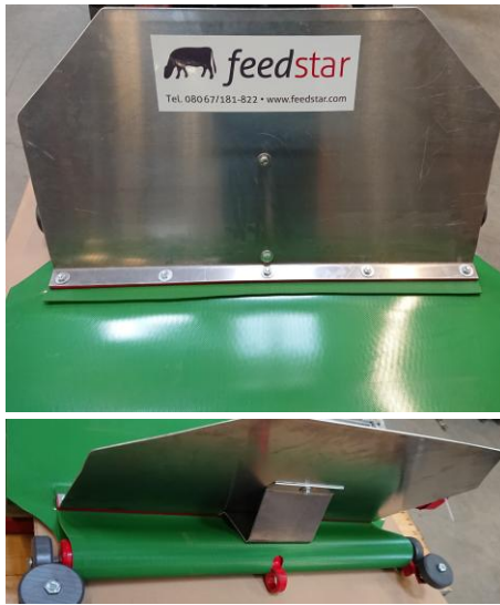
Abb. 27 Montage Schild Zugbalken
