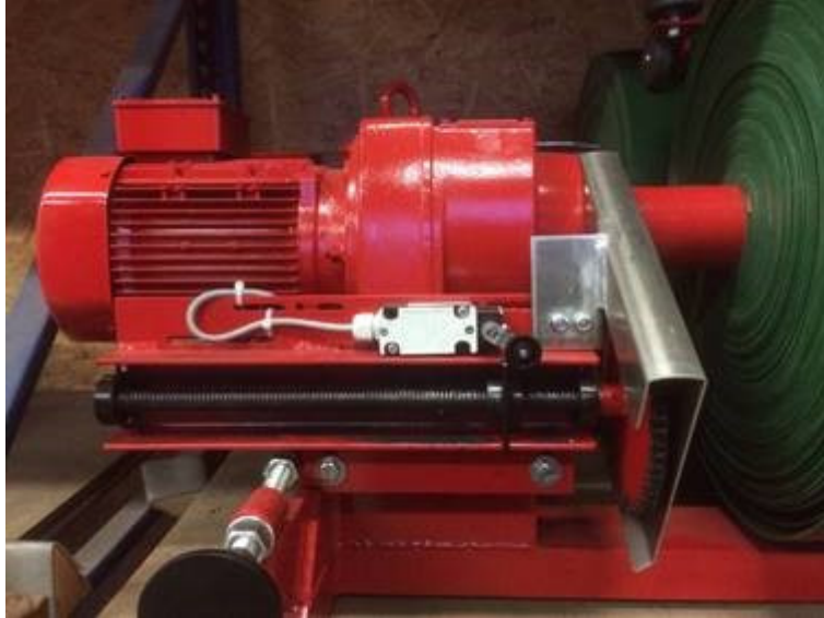
Abb. 3 Endabschaltung Rückrollvorrichtung (optional)
