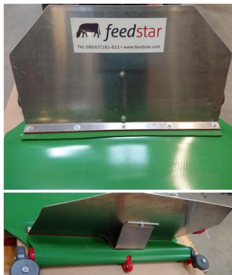
Slika 31 Montaža ojnice za znak
