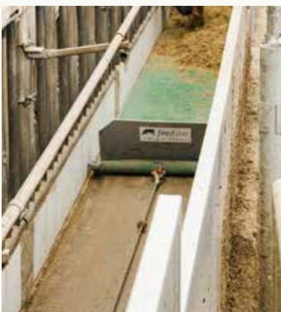
Mit unserem Spezialschild, das am vorderen Ende des Bandes auf dem Zugbalken befestigt ist, wird das Futter vollständig auf dem Band gehalten.
